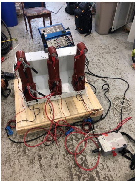
Obr. 8.2 Meranie prechodových odporov na VD4.
