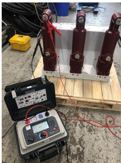
Obr. 8.1 Meranie izolačných stavov.
