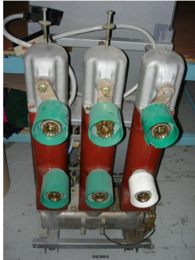
Obr. 3.3 Vypínač VF ABB plnený plynom SF 6 .
