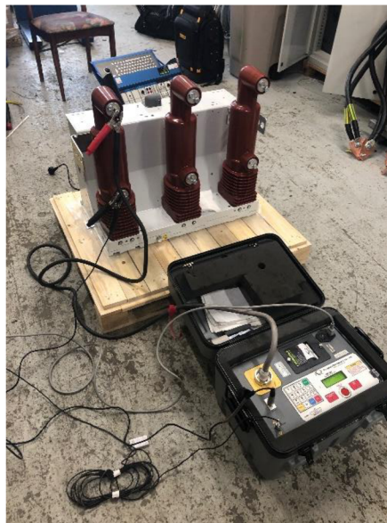
Obr. 8.6 Meranie kvality vákua.
