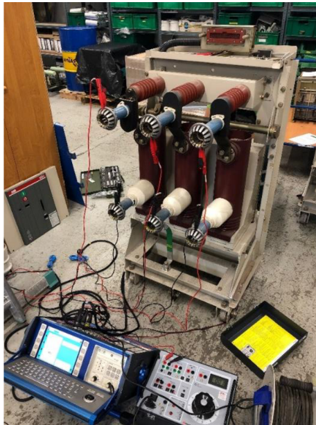
Obr. 8.7 Meranie vypínacích časov používaného vypínača VD4.
