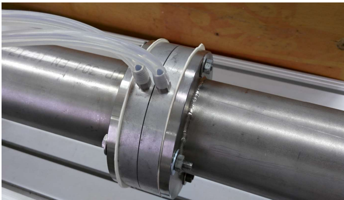
Obr. 3.8: Clona d/D=0,35 zabudovaná ve výtlačném potrubí.
