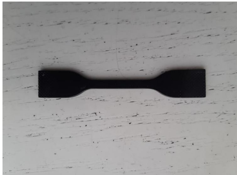
Obrázek 7.1 Vyražený zkušební vzorek ve tvaru lopatky
