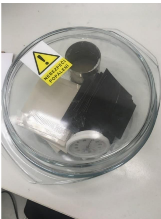
Obrázek 5.6 Uložení vzorků v prostředí pro kondicionování
