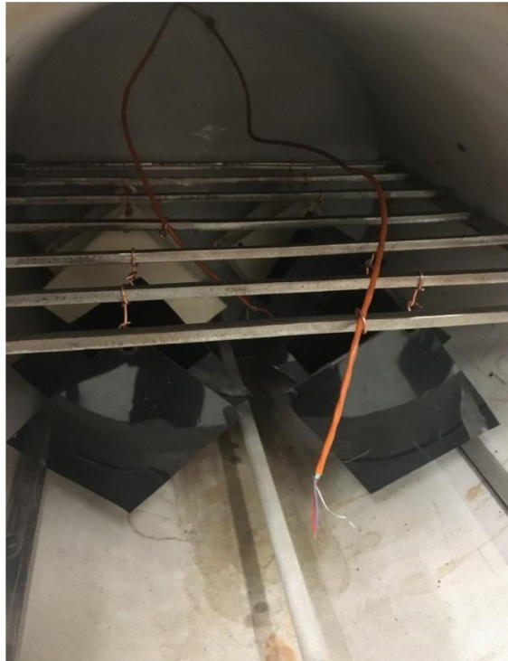
Obrázek 5.7 Zavěšení vzorků v peci
