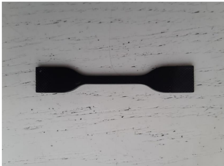
Obrázek 7.1 Vyražený zkušební vzorek ve tvaru lopatky
