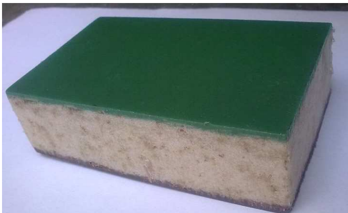
Obr. č. 19: Fotografie výřezu desky vytvořené při procesu PIM
