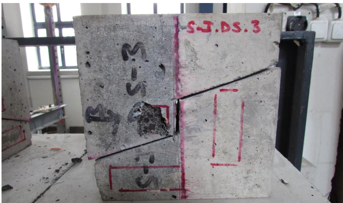
Obr. 100: Zkušební vzorek s náběhy po zkoušce
