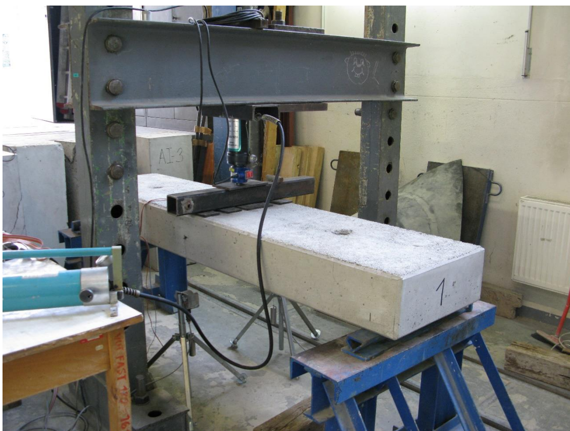
Obr. 85: Zkoušení příčného segmentu v třibodovém ohybu (SZK FAST VUT v Brně)
