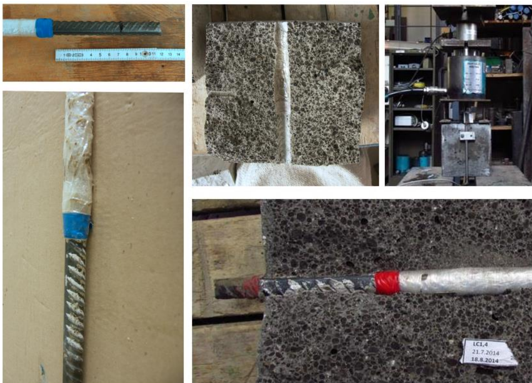
Obr. 60: Měření napětí v soudržnosti a porušená tělesa po zkoušce
