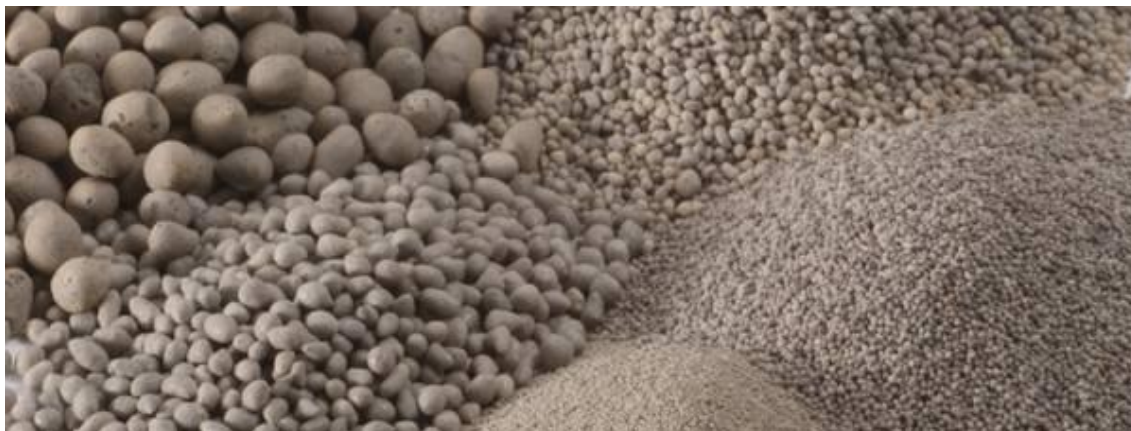
Obr. 24: Kamenivo na bázi zpěněného skla – různé frakce
