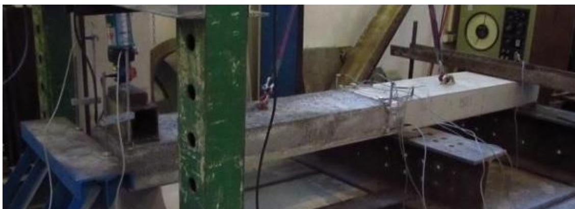
Obr. 109: Zkoušení balkonového nosníku v laboratořích SZK FAST VUT v Brně
