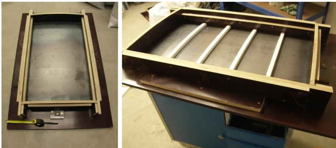
Obr. 87: Bednění segmentu klenby
