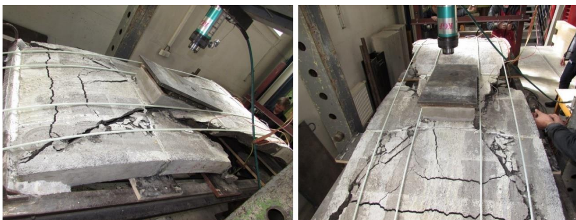
Obr. 92: Porušení předepjaté segmentové klenby
