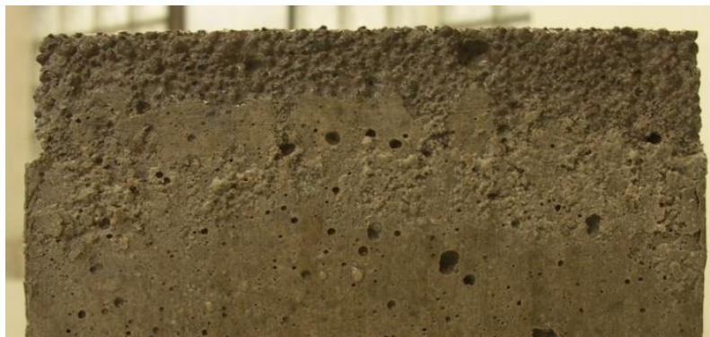
Obr. 37: Zkoušená dolní podstava po 150 cyklech (boční pohled)
