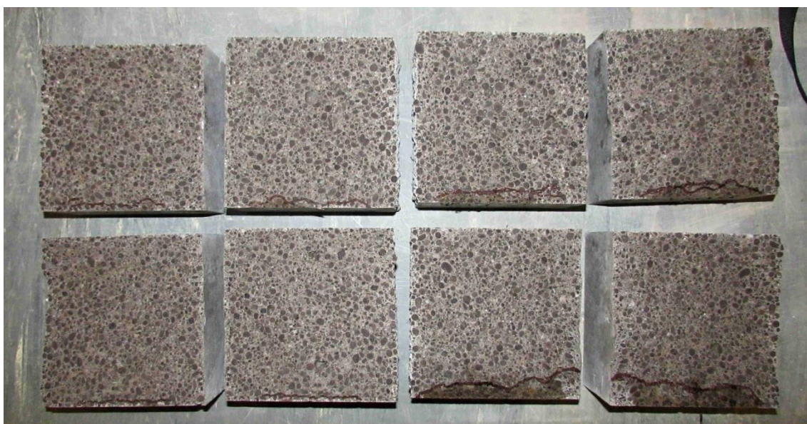
Obr. 47: Tělesa po zkoušce průsaku ULC D1,2eco
