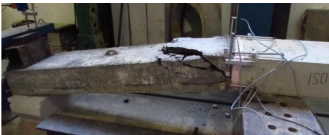
Obr. 110: Selhání balkonového prvku
