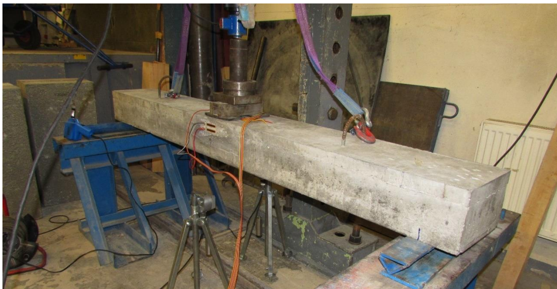
Obr. 96: Zatěžovací zkouška vrstveného nosníku třibodovým ohybem
