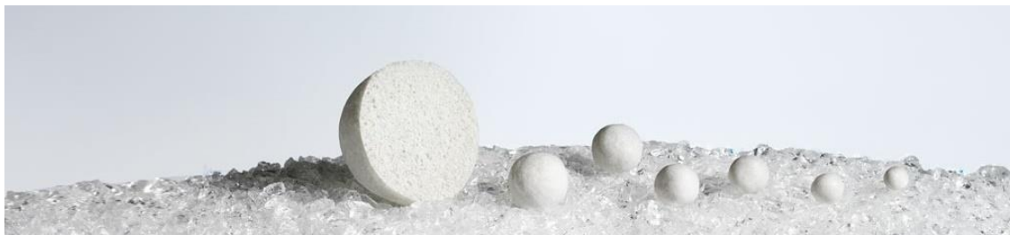
Obr. 29: Kamenivo Poraver - různé frakce a řez zrnem kameniva
