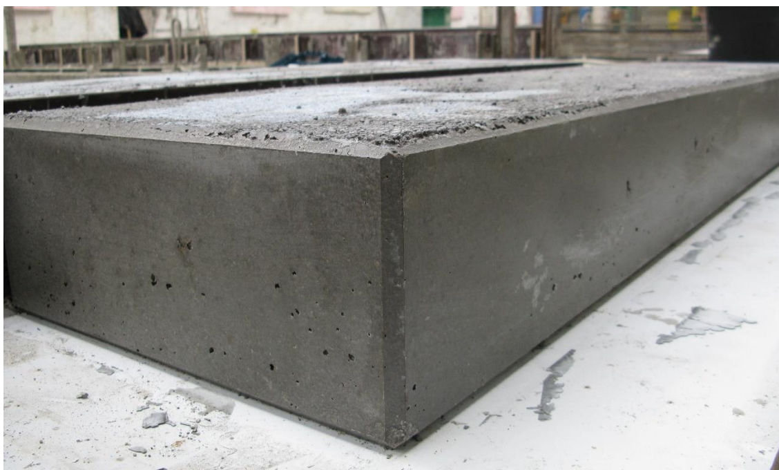
Obr. 84: Výplňový segment z lehkého betonu po odformování
