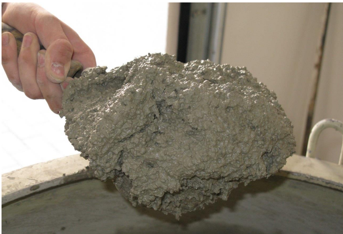
Obr. 23: Detail „nadýchané“ konzistence betonu ULC D1,0 - Liapor
