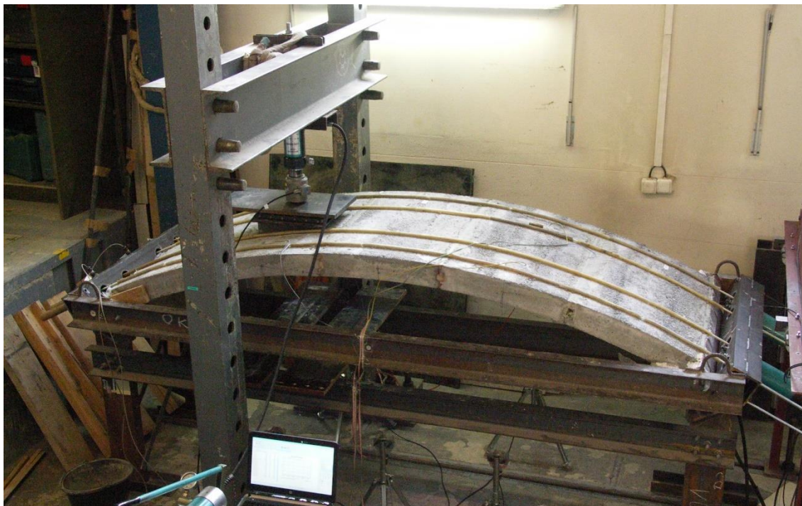
Obr. 90: Zkoušení klenby z lehkého betonu s předpínacími GFRP lany
