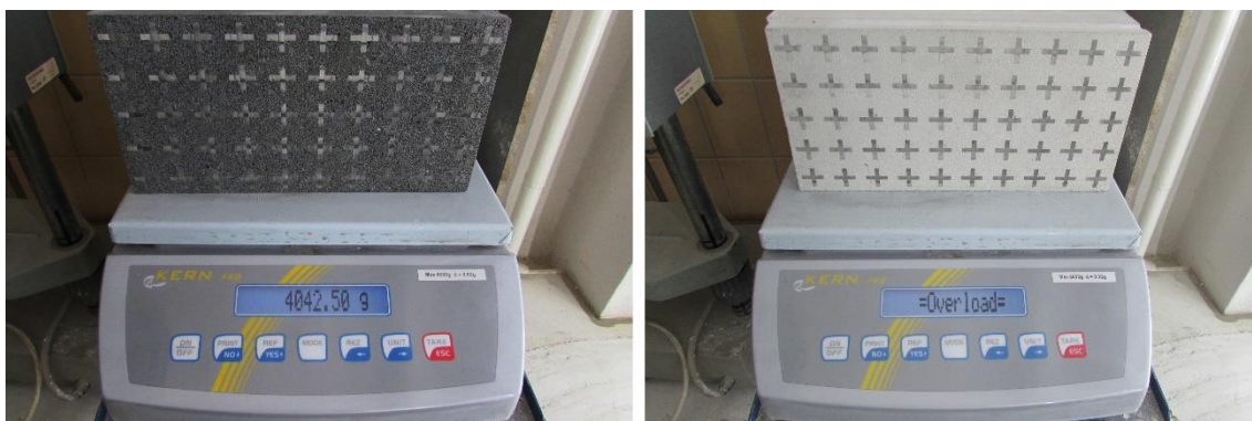
Obr. 115: Porovnání hmotnosti vylehčené a původní tvarovky na laboratorní váze s omezením 6 kg
