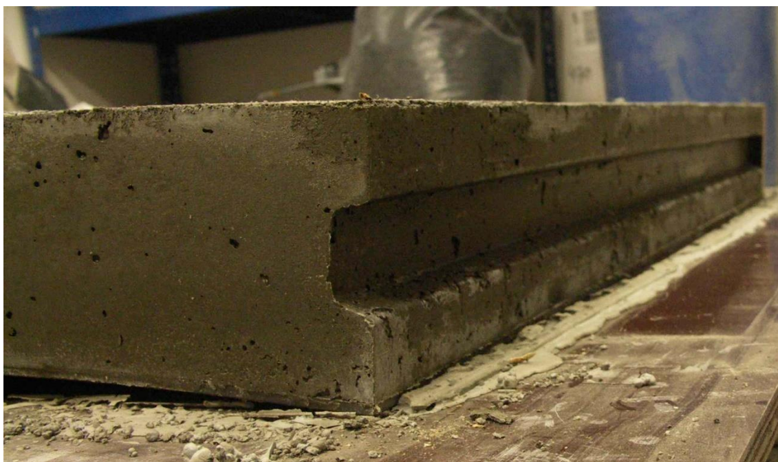
Obr. 88: Klenbový segment po odbednění s detailem zámku
