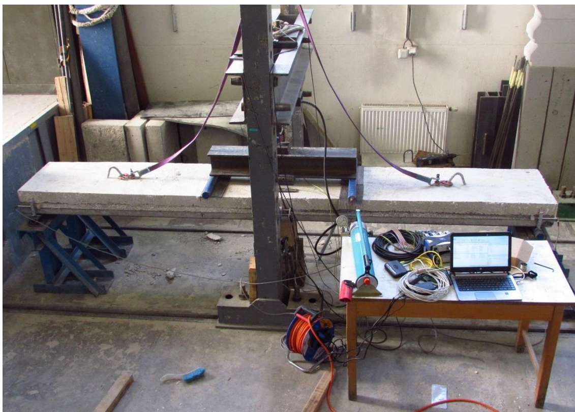
Obr. 104: Zatěžovací zkouška filigránového nosníku z ULC
