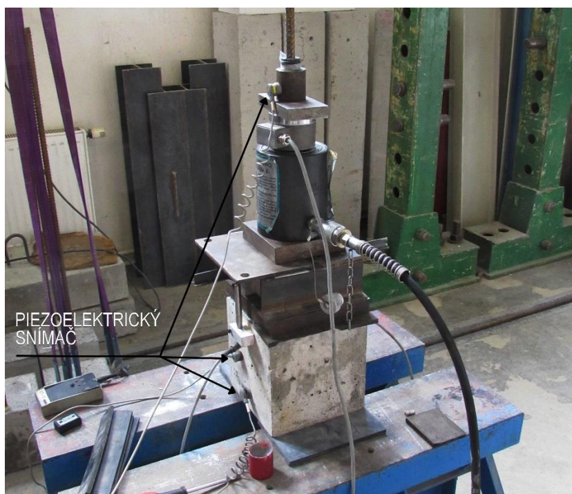
Obr. 78: Osazení snímačů pro měření akustické emise
