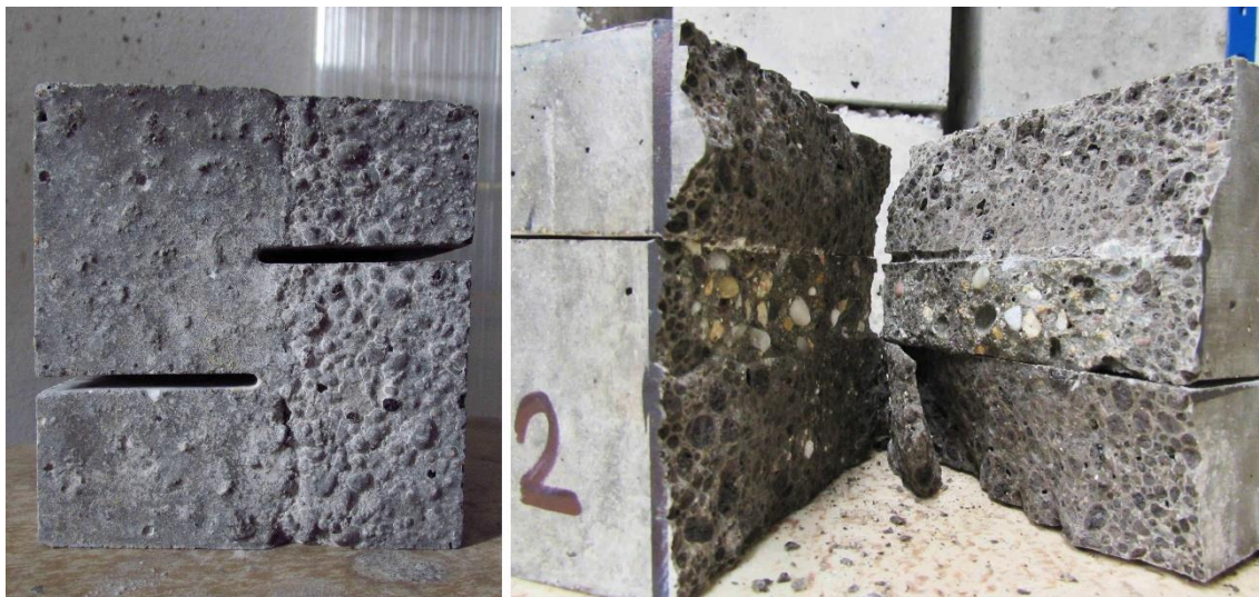
Obr. 99: Stanovení smykové únosnosti na krychli se zářezy
