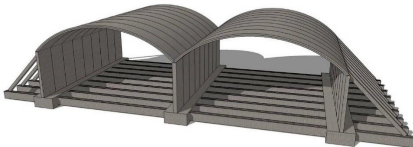
Obr. 82: Vizualizace monolitické varianty ekoduktů
