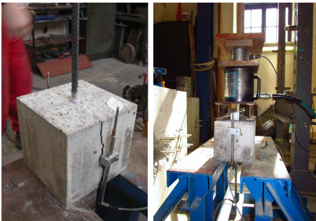
Obr. 59: Měření napětí v soudržnosti ULC D1,2eco a zkušební tělesa po zkoušce
