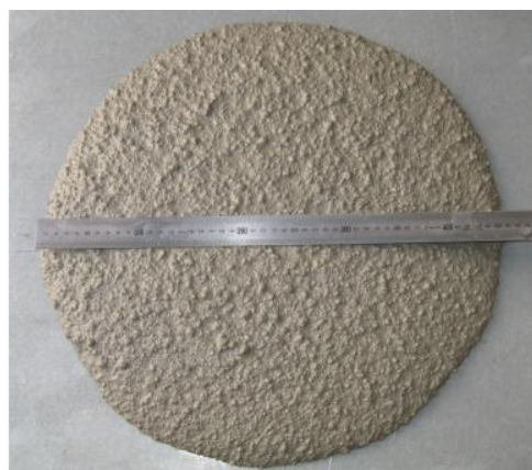
Obr. 22: Způsob měření stupně rozlití a stupeň rozlití F3 (450 mm) ULC D1,0 – Liapor
