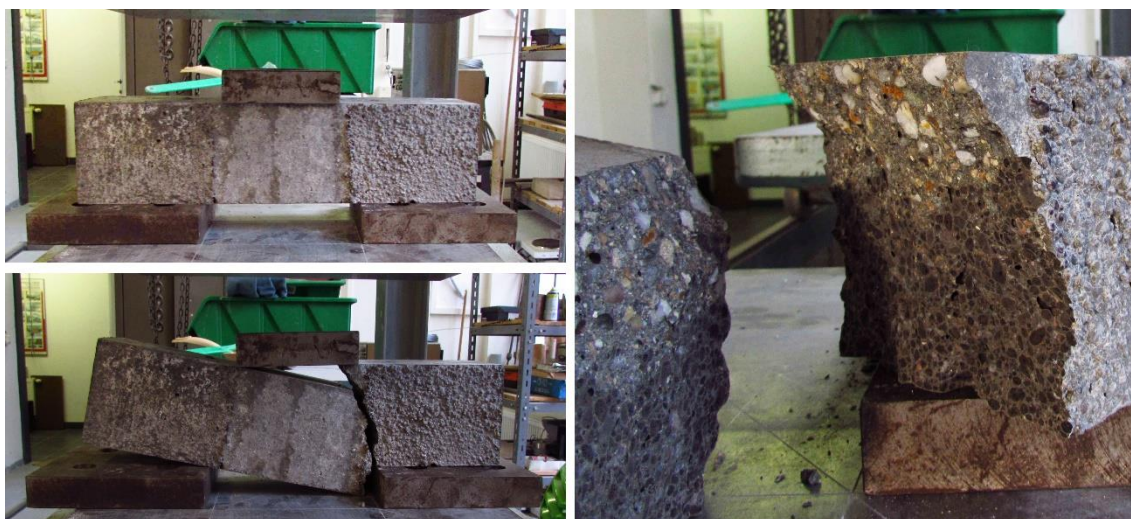
Obr. 98: Stanovení smykové únosnosti na trámci
