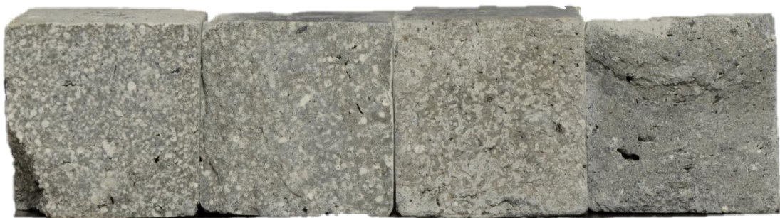
Obrázok 13: Rozloženie častíc v pripravených vzorkách (zľava 60-40; 70:30; 80:20; 90:10)
