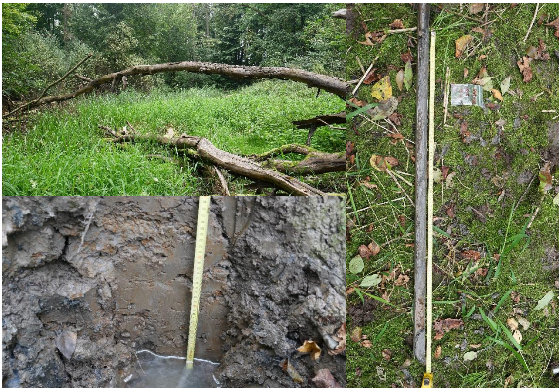
Obr. 9: lokalita odběru jádra RZO4, starý zazemněný meandr (vlevo nahoře), jádrovnice s odebraným sedimentem a měřítkem (vpravo), kopaná sonda s měřítkem (vlevo dole) (vlastní fotografie, 16. 9. 2021).
