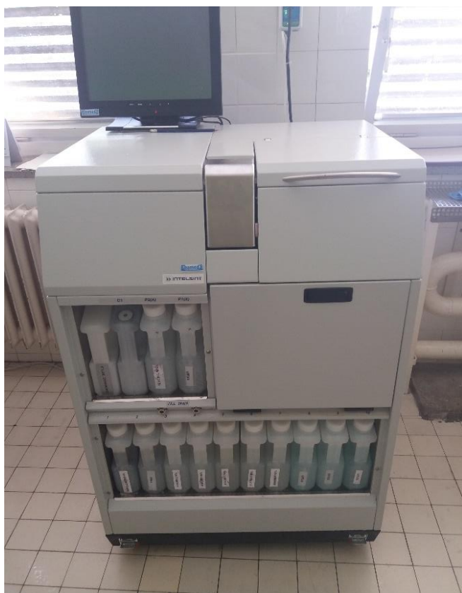
Obr.8 Odvodňovací tkáňový automat (autotechnikon)
