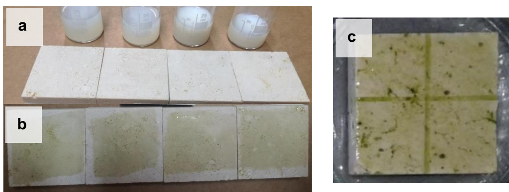
Obrázek 22: (a) Na travertin nanášené testované fotokatalyticky aktivní suspenze. (b) Ošetřené kvádry s řasovým inokulem a fólií. (c) Ošetřený kvádr rozdělený na kvadranty.
