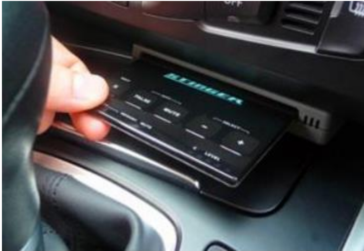
Obrázek č. 15 - Detektory namontované napevno
