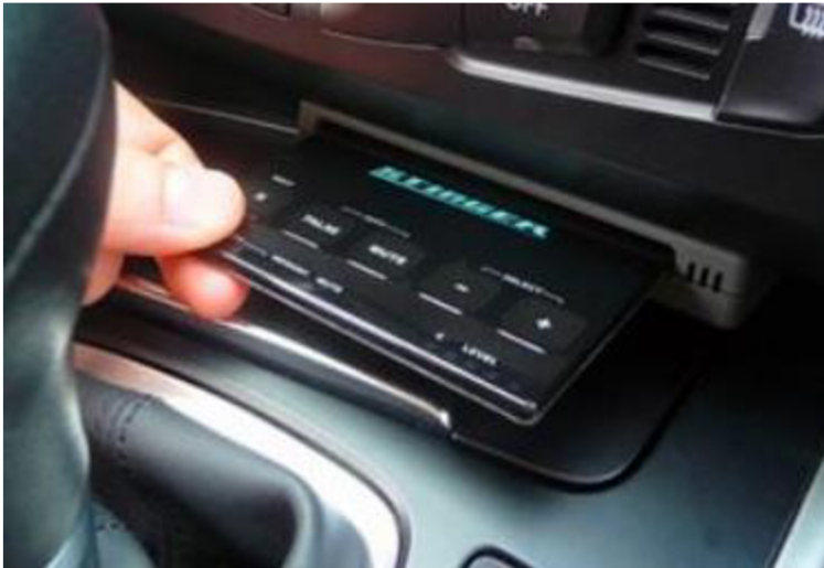
Obrázek č. 15 - Detektory namontované napevno
