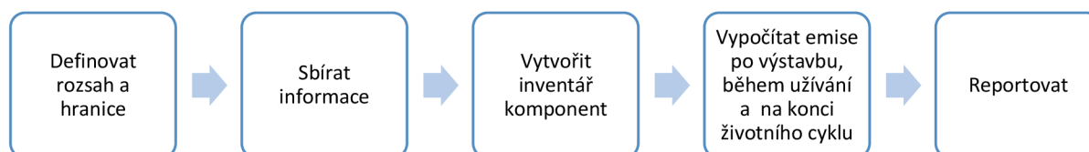
Obrázek 25 Kroky výpočtu uhlíkové stopy za celý životní cyklus dle přístupu Velké Británie [62]
