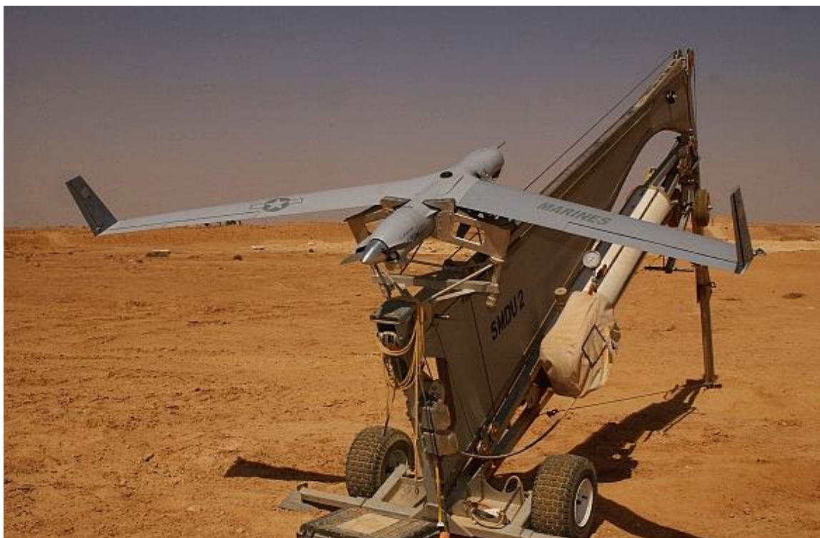
Obr. 17 Letoun ScanEagle na startovacím katapultu SuperWedge
