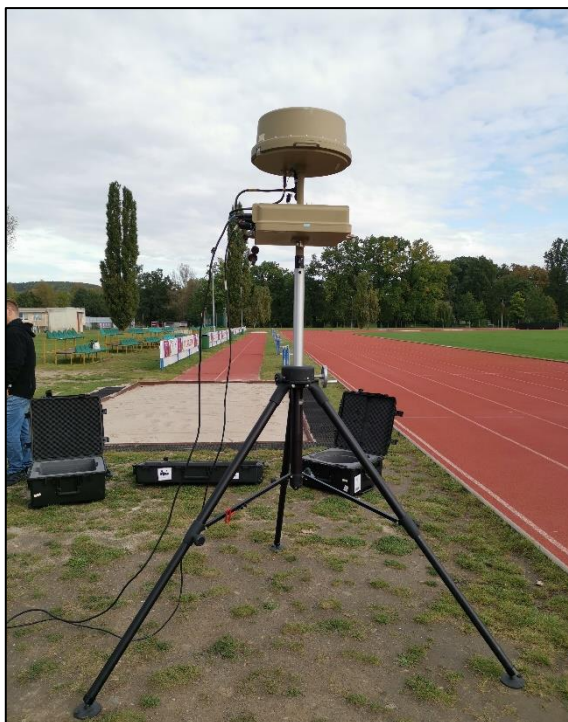
Obr. 9 Radar systému Antidron
