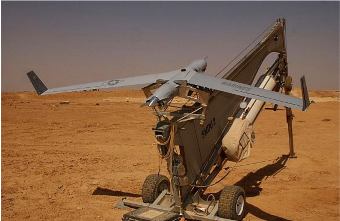
Obr. 17 Letoun ScanEagle na startovacím katapultu SuperWedge
