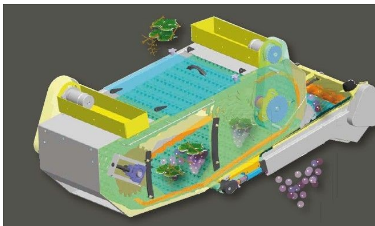
Obr. 8 Separační systém Cleantech Vario Zdroj: oficiální foto
