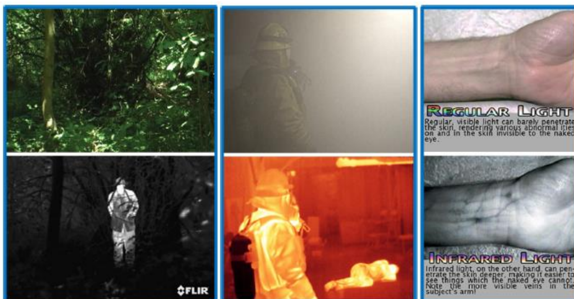
Obrázek 1 Porovnání snímků ve viditelné oblasti (horní řádek) a IR oblasti (dolní řádek), kde vlevo je příklad vojenského průzkumu okolí, vprostřed je využití pro hasiče a vpravo je využití v medicíně. Převzato z [9].
