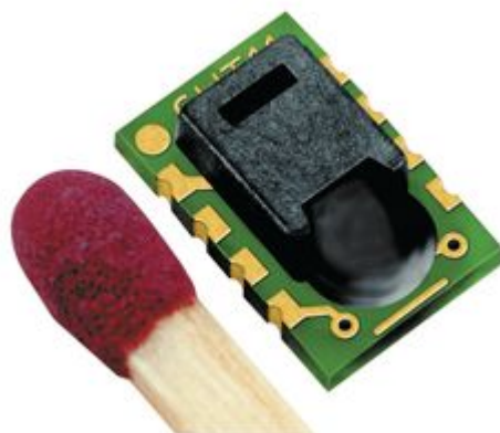
Obrázek 9 – Inteligentní čidlo SHT11 [14]
