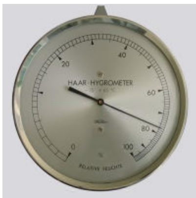
Obrázek 12 - Klasický vlasový vlhkoměr [9]
