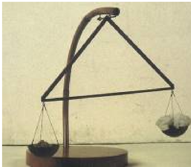
Obrázek 5 – Model Leonardova vlhkoměru [13]
