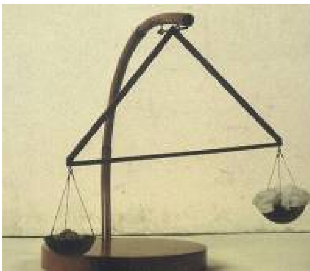
Obrázek 5 – Model Leonardova vlhkoměru [13]
