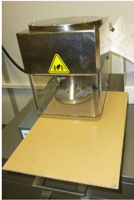
Obrázek 20- Pevnost lepenky v průtlaku, fotografovala: Zuzana Daňková
