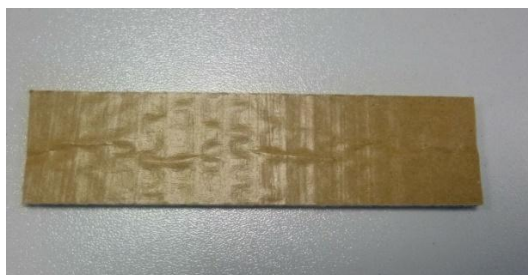
Obrázek 24 - Lepenkový zkušební vzorek po provedení ECT testu, fotografovala:
