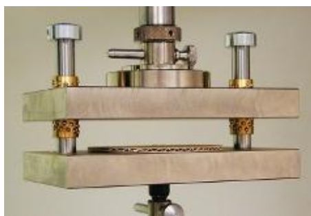
Obrázek 19 - FCT test, Pilous-packaging
