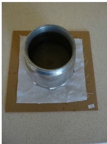
Obrázek 23 - Zkouška odolnosti vůči působení vlhkého tepla, fotografovala: Zuzana Daňková
