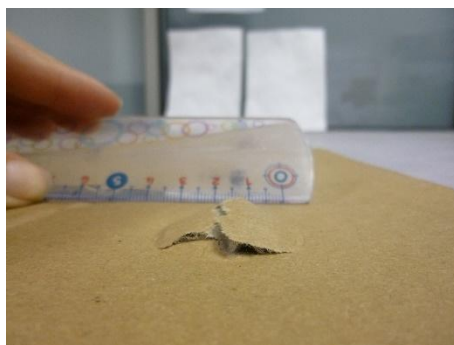
Obrázek 26 - oblast poškození vzorku po provedení zkoušky pevnosti v průtlaku, fotografovala: Zuzana Daňková
