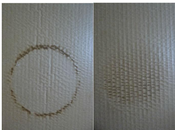
Obrázek 27 - Prostup vlhkosti vzorkem během zkoušky odolnosti vůči vlhkému teplu, fotografovala: Zuzana Daňková
