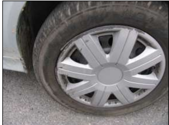
Obr. č. 31 - Poškození krytu pravého předního kola, viz označnick č. 2 na obr. č. 32[16]
