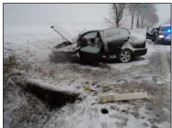
Obr. č. 106 - Vozidlo Škoda v konečné poloze po nárazu do betonového mostku[16]
