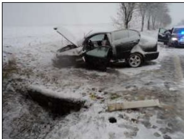
Obr. č. 112 - Poškozen vozidlo po nárazu do betonového mostku[16]
