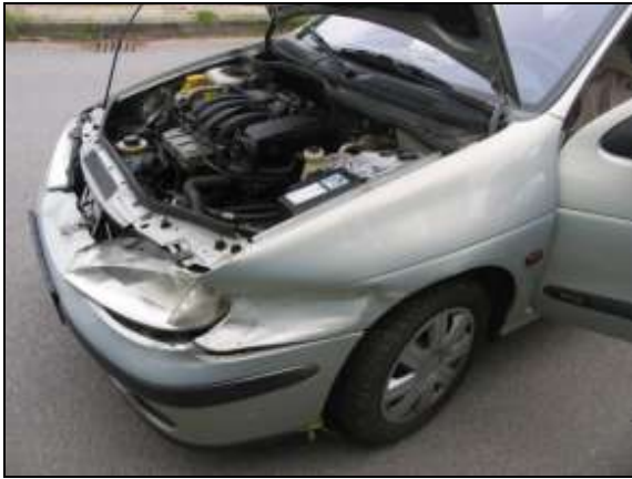
Obr. č. 30 - Poškození levé přední části vozidla od svodidel, viz označnick č. 3 na obr. č. 33[16]
