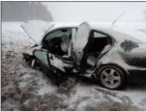
Obr. č. 103 - Celkové poškození vozidla v konečné poloze[16]
