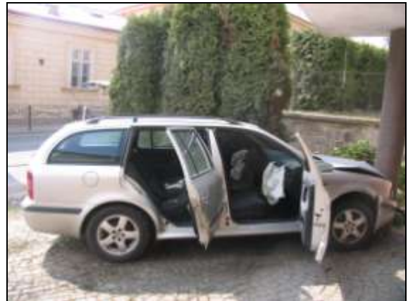
Obr. č. 72 - Pohled na celkové poškození vozidla[16]
