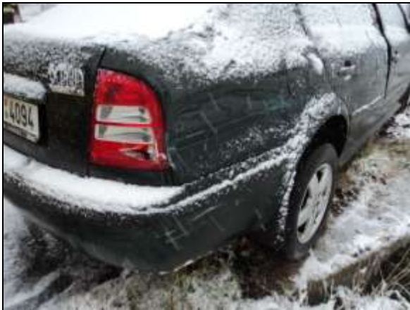
Obr. č. 101 - Poškození pravé zadní části vozidla od svodidel[16]
