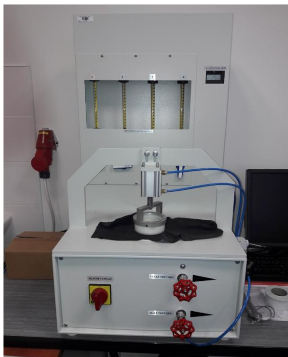
Obrázek 27 - Přístroj na měření prodyšnosti [vlastní]
