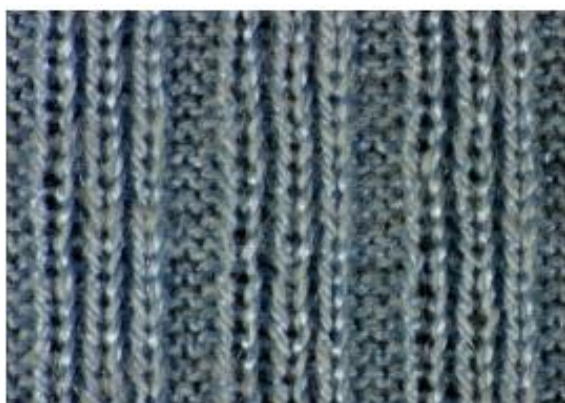
Obrázek 4 - Žebrová pletenina oboulící [54]
