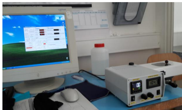
Obrázek 47 - Přístroj PERMETEST [vlastní]
