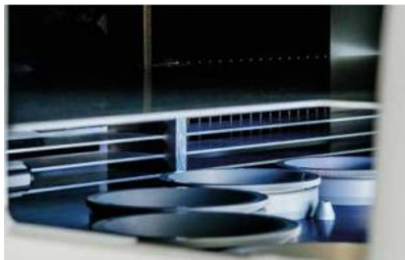
Obrázek 50 - Přístroj CupMaster FX 3180, umístění misek uvnitř přístroje [55]
