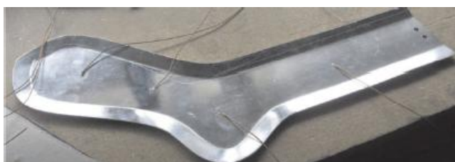
Obrázek 7 - Umístění termočlánků v horké desce [27]
