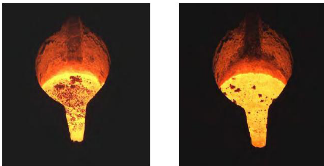
Obr. 3.6 Rozdíl množství strusky s předslitinou MgFeSi a CompactMag [1]
