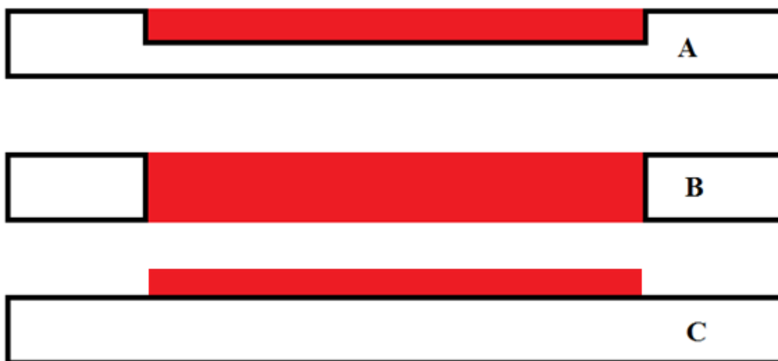
Obrázek 16 - boční průřez Geocoinem, varianty A, B, C; červená plocha značí místo pro umístění dílu s NFC čipem. Díl s NFC čipem může být vyroben z libovolného materiálu, kterým projde indukční signál (např. dřevo, plast). Uvnitř dílu bude osazen NFC čip. (zdroj autor)
