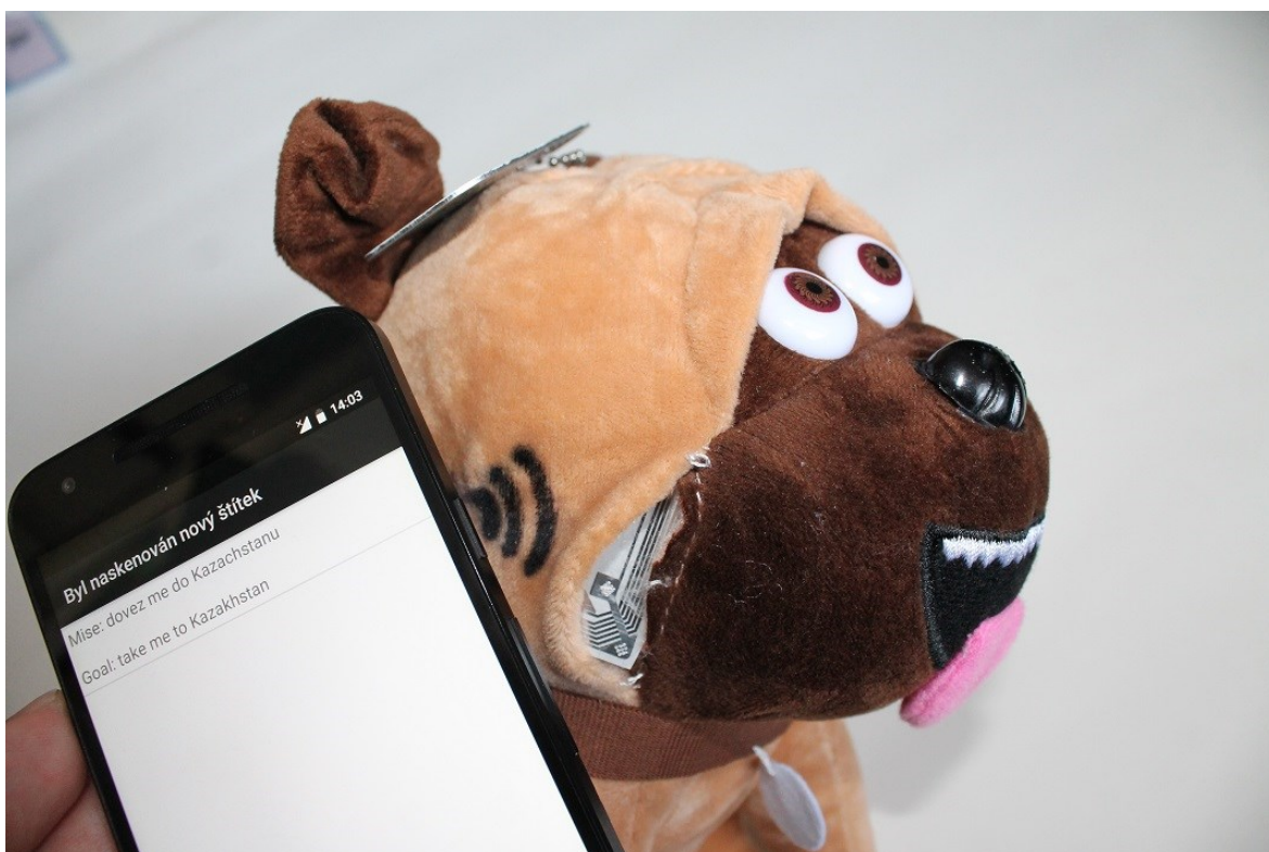
Obrázek 20 - ukázka plyšáka se zabudovaným NFC čipem. Pro lepší znázornění je část švu plyšáka vypáraná, aby byl viditelný NFC čip. (zdroj autor)
