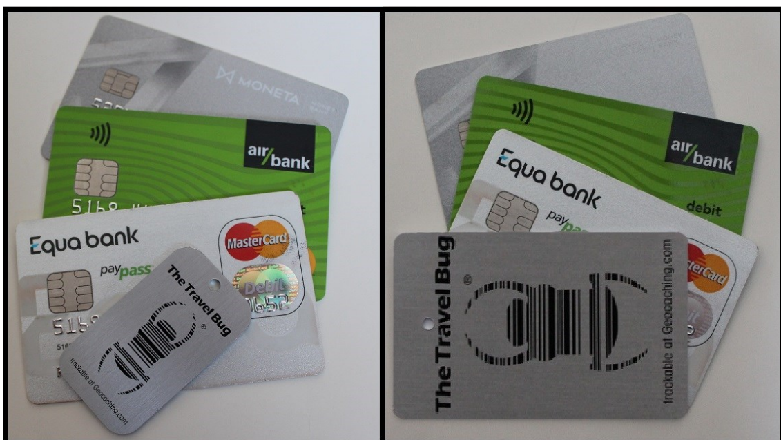
Obrázek 18 - plastová karta s NFC čipem použitá jako Travel bug ve 2 velikostech a její srovnání s platebními kartami vybraných českých bank. Vlevo je potištěna plastová karta s NFC čipem o velikosti platební samolepky, vpravo potištěna plastová karta s NFC čipem standardní velikosti dle normy ISO/IEC 7810. (zdroj autor)
