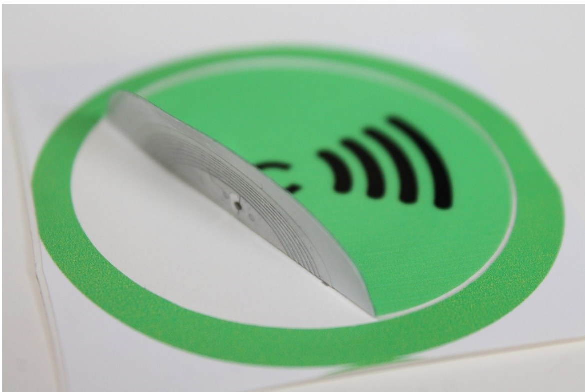
Obrázek 19 - kulatá samolepka s NFC čipem, kterou je možné nalepit na rubovou stranu Geocoinu. (zdroj autor)
