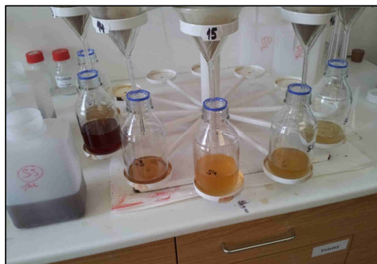
Statické testy vyluhovatelnosti – výluhy různých materiálů
