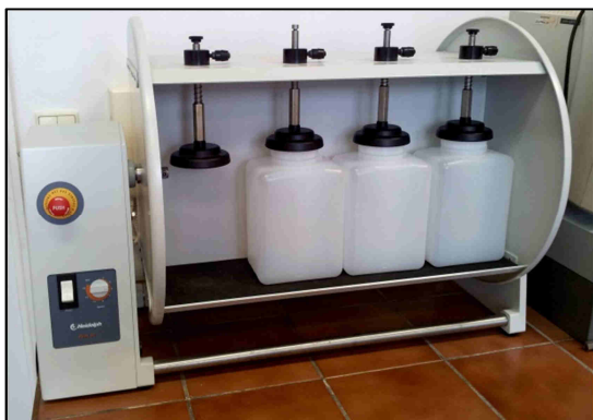
Statické testy vyluhovatelnosti – rotační třepačka
