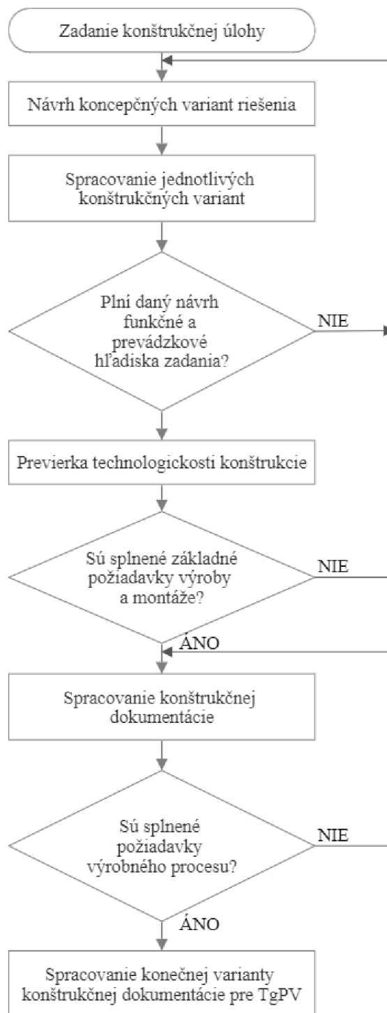
Obr. 8 Schéma účelového postupu konstrukčného riešenia výrobku, upravené podľa [9].
