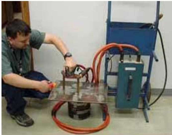
Obr. 30 Zkoušení přenosným proudovým zdrojem pomocí měděných elektrod [16]
