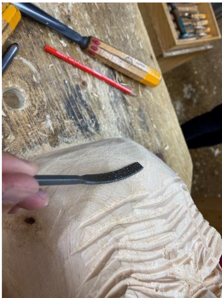
Obrázek 29 - Úprava povrchu rašplí
