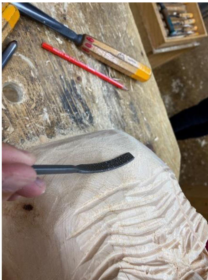
Obrázek 29 - Úprava povrchu rašplí
