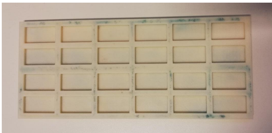
Obrázek 11: forma pro gelové vzorky
