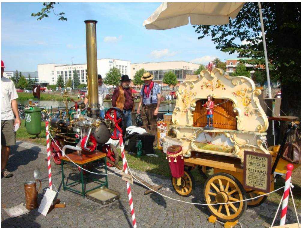
Obr. 15 Flašinet poháněný malou parní lokomotivou
