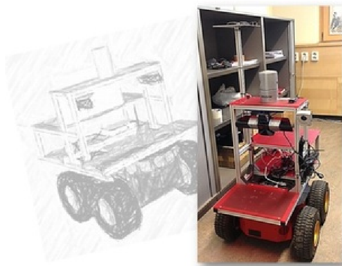
Obrázok 2.6: Obrázok robota typu Pioneer (Toad), ktorý sa nachádza na Fakulte Informačných Techológií. Prevzaté z [8].
