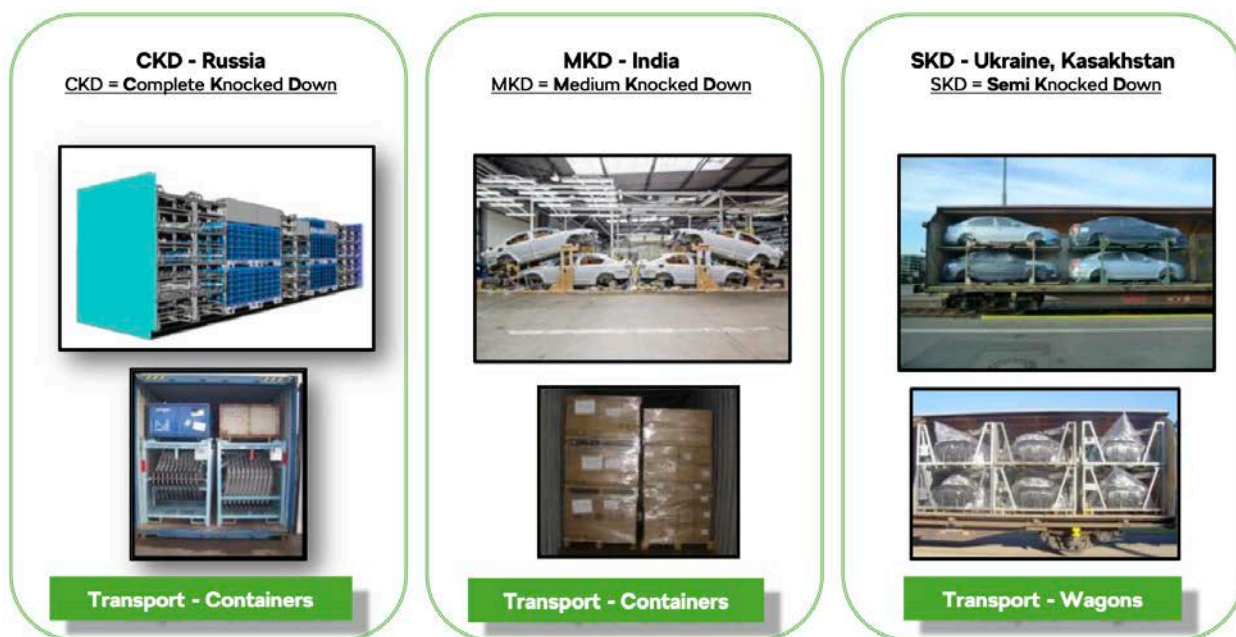
Obr. 2 Klasifikace dovážených dílů a komponent podle stupně rozložení vozů
