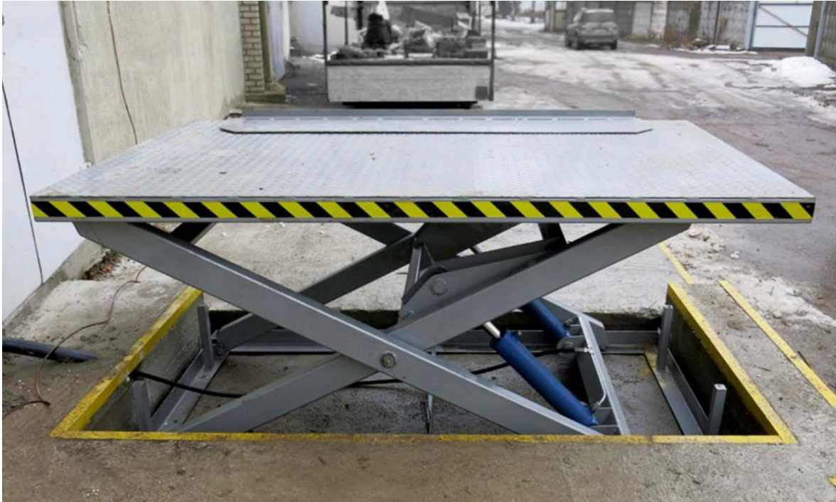
Obr. 5 Příklad možného využití hydraulického zvedacího stolu v CKD centru
