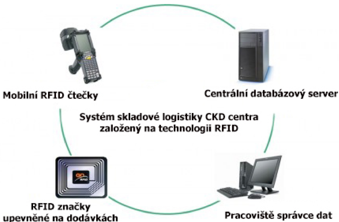
Obr. 4 Aplikace radiofrekvenční identifikace zboží v CKD centru
