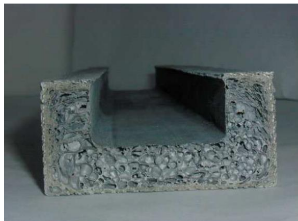
Obr.2.9 Zaválcovaný plech v hliníkové pěně [16]
