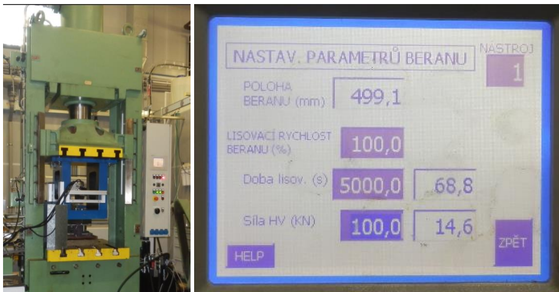
Obr. 3.5 Pohled na hydraulický lis CB 300/63 a na jeho monitor s nastavením potřebných hodnot lisovacích parametrů
