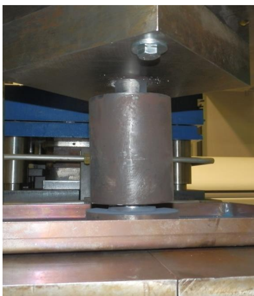
Obr. 3.7 Pohled na lisování chloridu sodného do taveniny příslušné slitiny za pomoci hydraulického lisu CB 300/63
