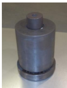
Obr. 3.3 Použitá slévárenská forma pro výrobu porézních kovů (vlevo); schéma její dutiny (vpravo)
