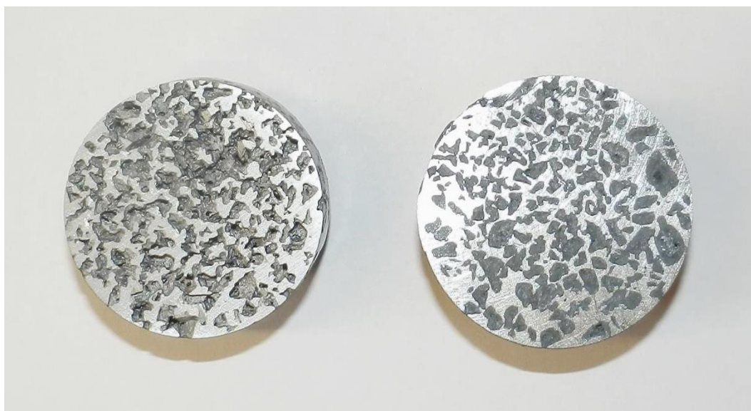
Obr. 3.8 a) Půdorysný pohled na vyrobené vzorky porézních materiálů, ze slitiny AlSi12 – vlevo a ze slitiny ZnAl4 – vpravo
