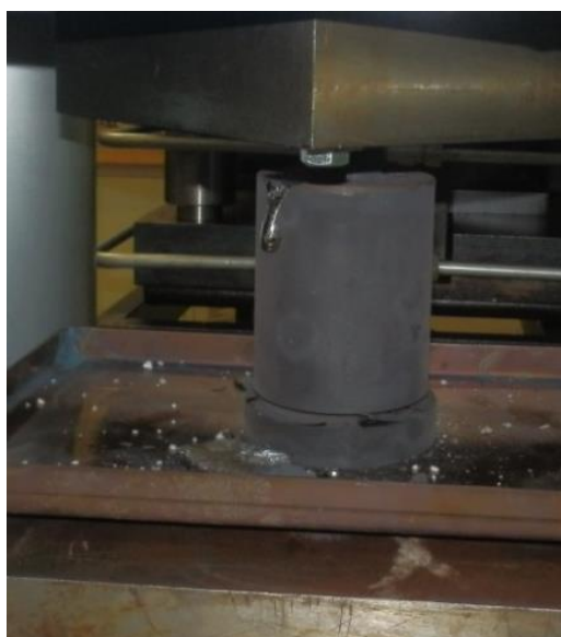
Obr. 3.7 Pohled na lisování chloridu sodného do taveniny příslušné slitiny za pomoci hydraulického lisu CB 300/63
