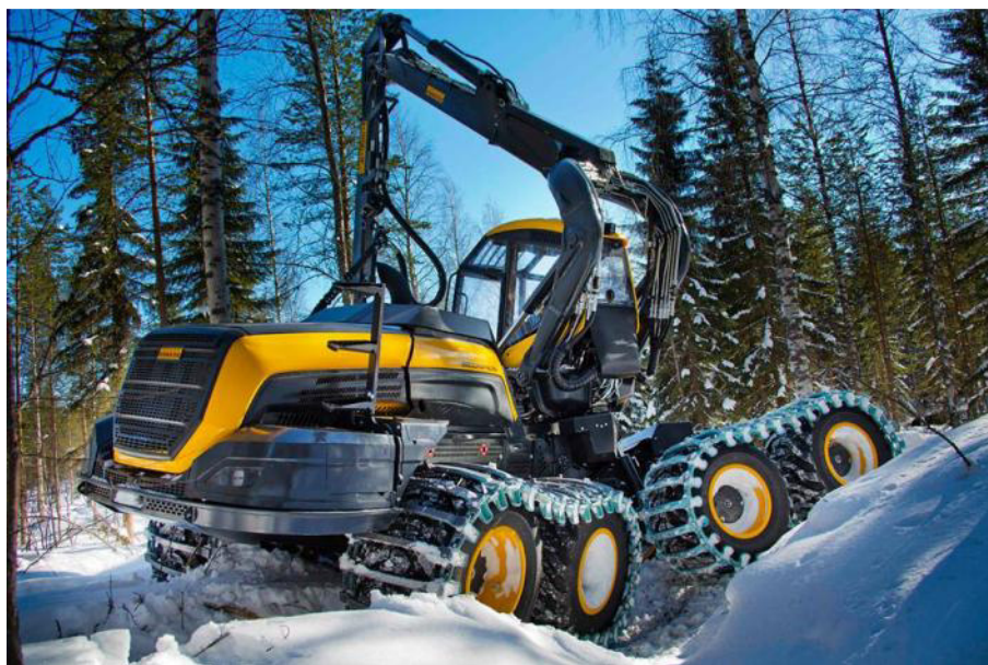
Obrázek 14: Maximální přizpůsobení podvozku povrchu (www.ponsse.com)
