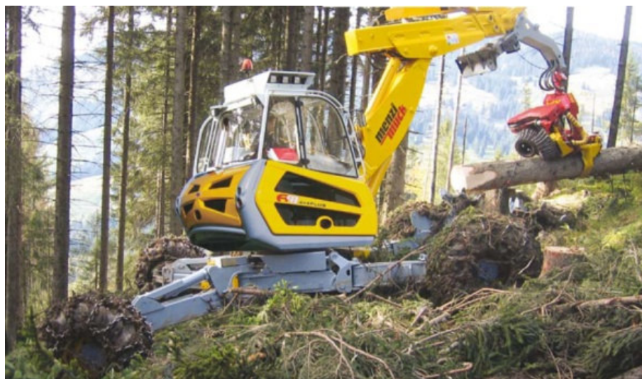
Obrázek 3: Kráčivý harvestor Menzi Muck ( www.mountec-corp.com )
