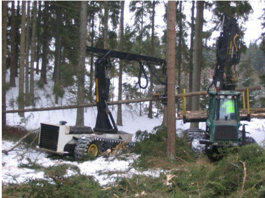
Obrázek 24: Systém The Beast při nakládce dříví na vyvážecí traktor (Nordén B.)
