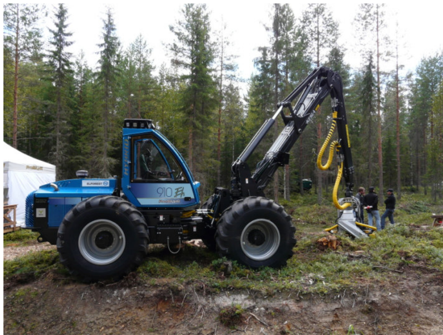
Obrázek 19: Harvester firmy ProSilva s hybridním pohonem od El-Forest hybridním pohonem (foto Klvač R.)
