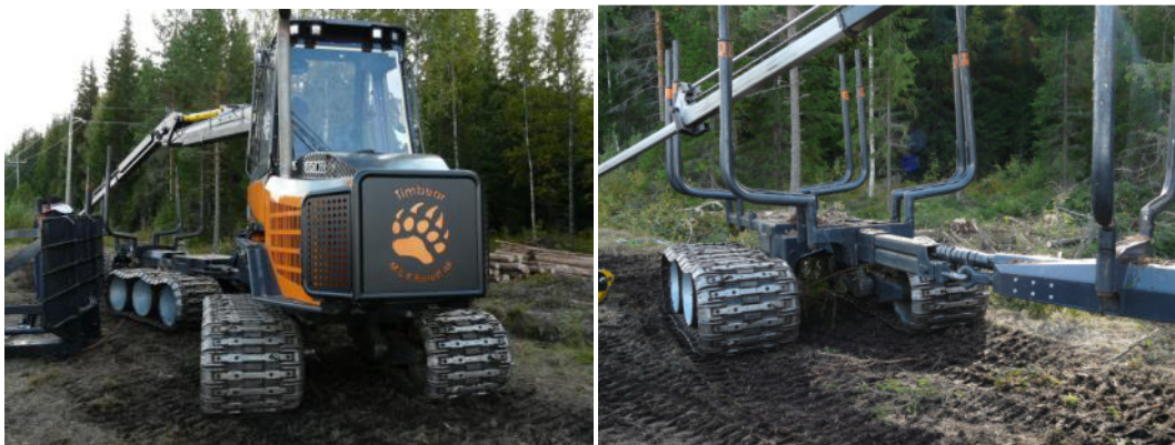
Obrázky 17 a 18: Kombinovaný stroj (vyvážecí traktor přestavitelný na harvester) Timbear Lightlogg C s dvěma ložnými prostory (foto Klvač R.)
