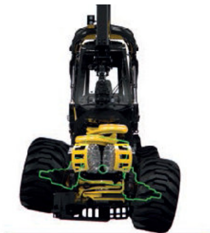
Obrázek 13: Nivelace podvozku stroje Scorpion (PonssePlc.)
