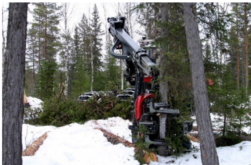
Obrázek 22: Harvestorový jeřáb „Angled“ crane s horizontálním vykloněním ( www.epsilon.slu.se )
