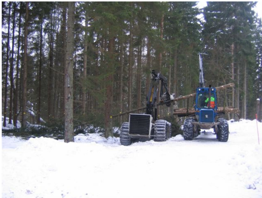
Obrázek 23: Bezoperátorový harvester The Beast (vlevo) s vyvážecí soupravou (vpravo) (Nordén B.)
