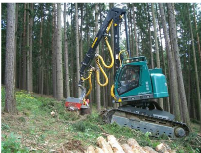
Obrázek 2: Pásový harvestor Neuson ( www.neuson-ecotec.com )
