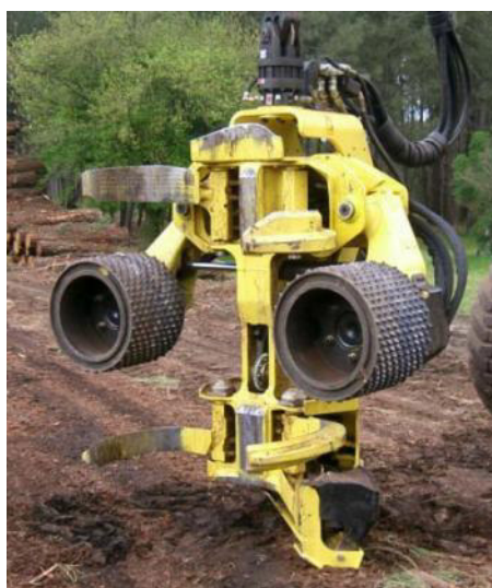
Obrázky 8 a 9: Harvestorová hlavice finského typu (vlevo ( www.ponsse.com )) a švédského typu (vpravo ( www.merimex.cz ))
