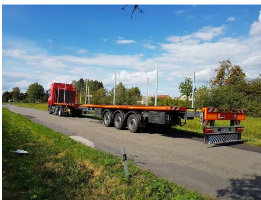
Obr. 1.11 Silniční návěs teleskopicky prodloužený na přepravu 45' kontejneru
