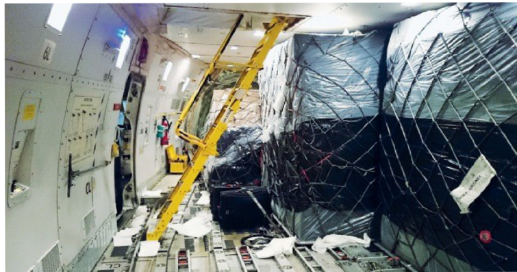
Obr. 3.4 Palety s nákladem na hlavní palubě letadla Boeing 747-400 F
