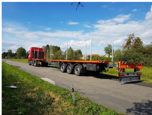
Obr. 1.11 Silniční návěs teleskopicky prodloužený na přepravu 45' kontejneru
