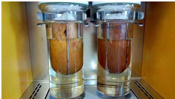
Obrázek 7: Extrakce olejové frakce SCG v SoxThermu
