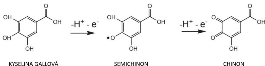
Obrázek 3: Reakční schéma oxidace kyseliny gallové pomocí elektrochemického procesu [51]
