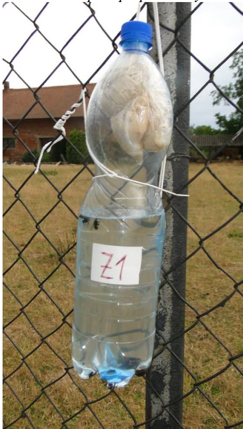
Obrázek 16: sběrná nádoba na materiál s obsahem 70 % etanolu
