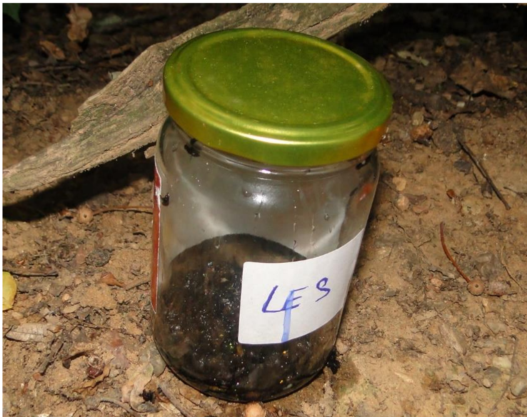
Obrázek 16: sběrná nádoba na materiál s obsahem 70 % etanolu
