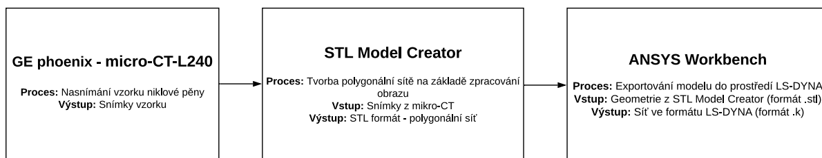
Obrázek 5.6: Postup vytváření konečnoprvkové sítě za účelem získání kompatibilního formátu s programem LS-DYNA.
