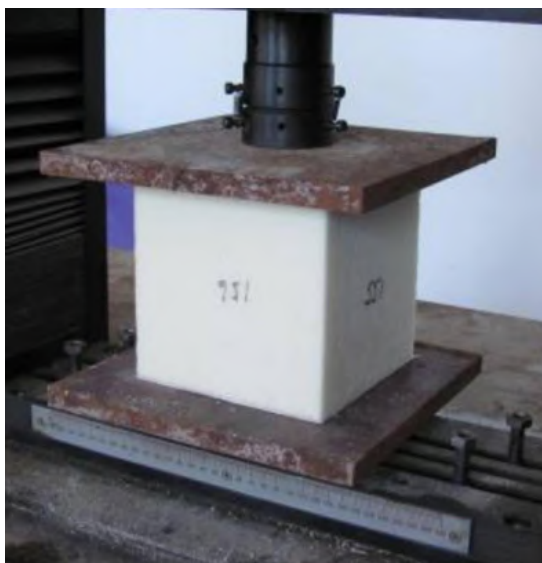
Obrázek 5.1: Tlaková zkouška pěnového materiálu [26].
