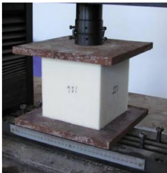
Obrázek 5.1: Tlaková zkouška pěnového materiálu [26].
