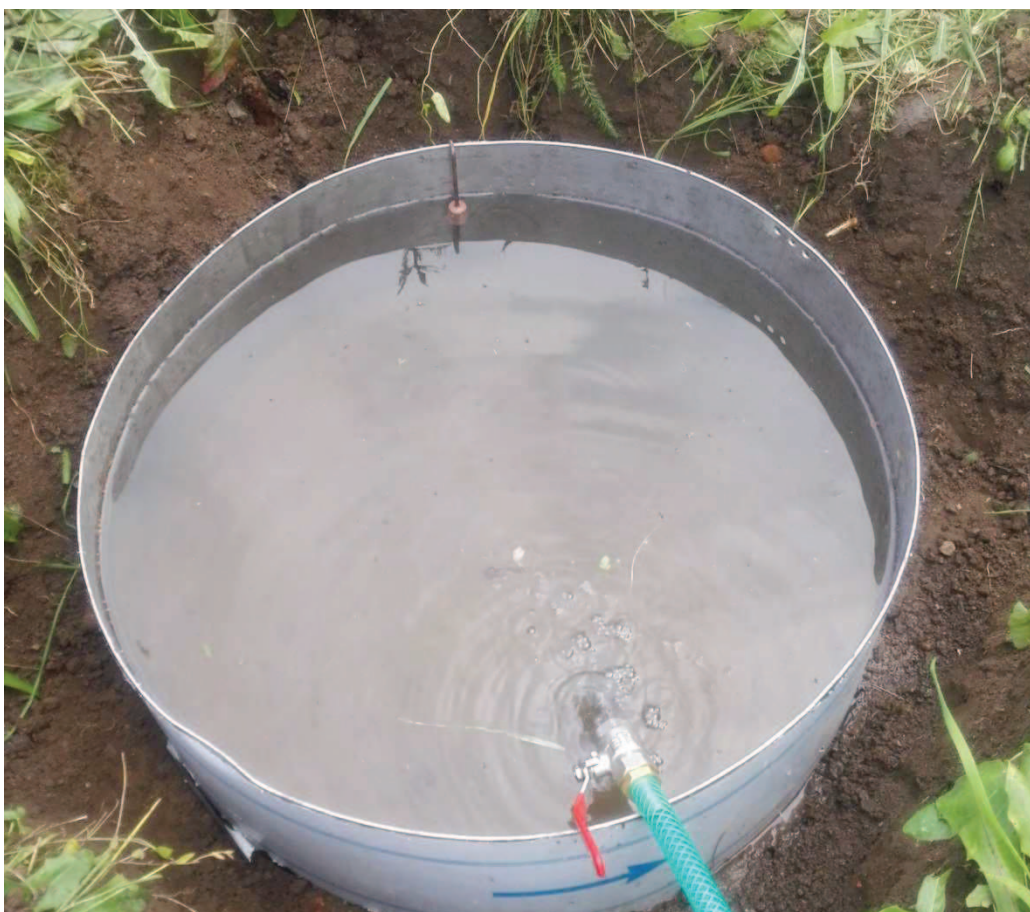
Obr. 11 Čerpání vody do vsakovacího válce
