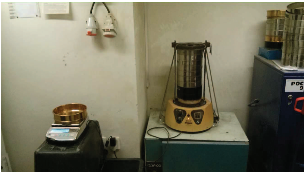
Obr. 18 Sada sít s vhodně zvolenými otvory pro síťový rozbor zeminy
