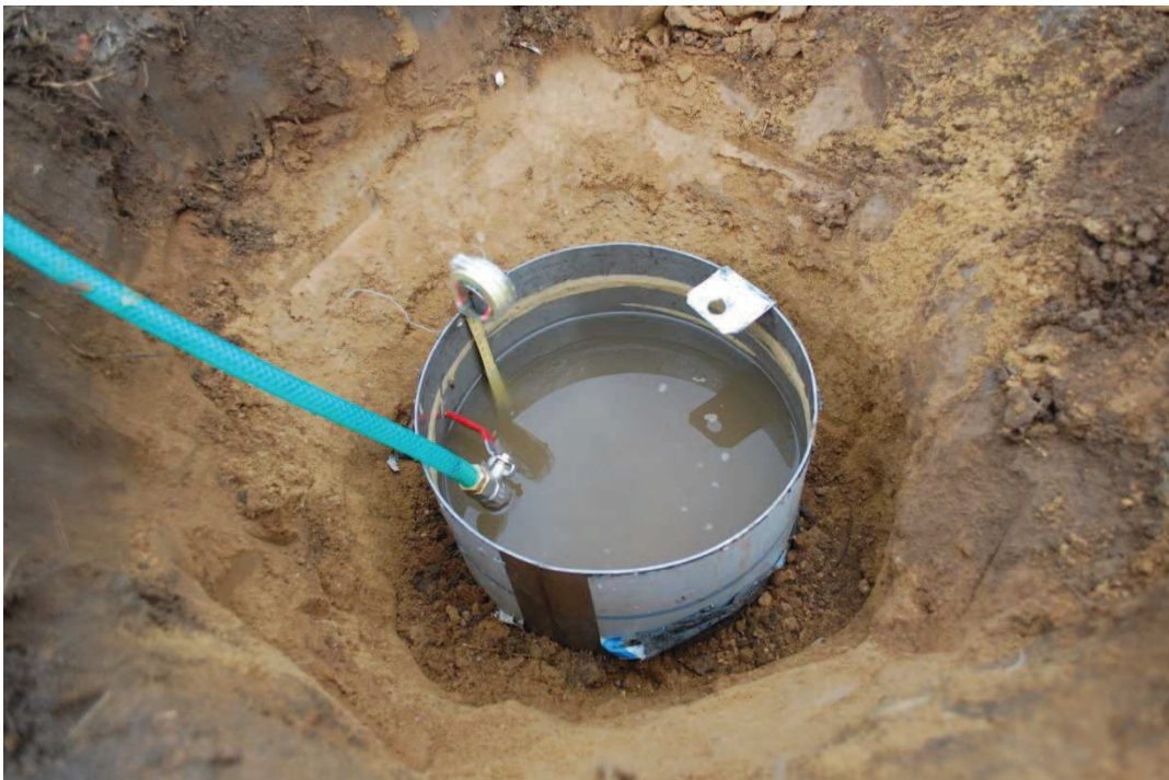
Plnění vsakovacího válce
