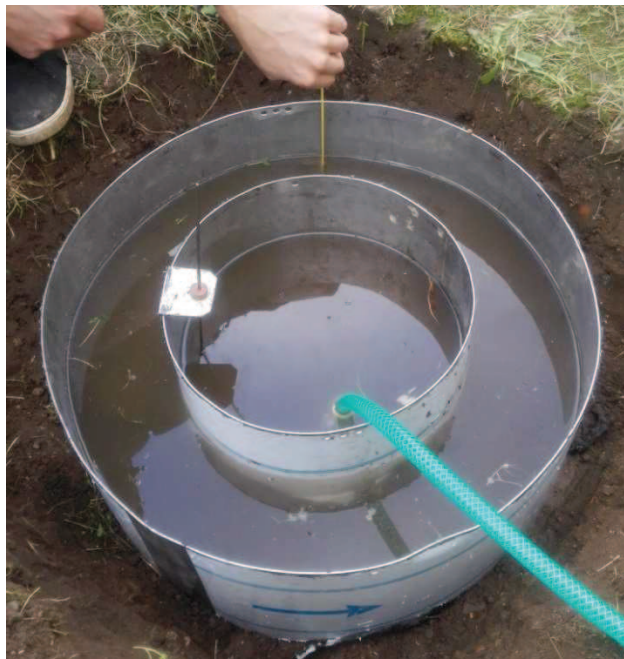
Plnění vsakovacího dvojjálce
