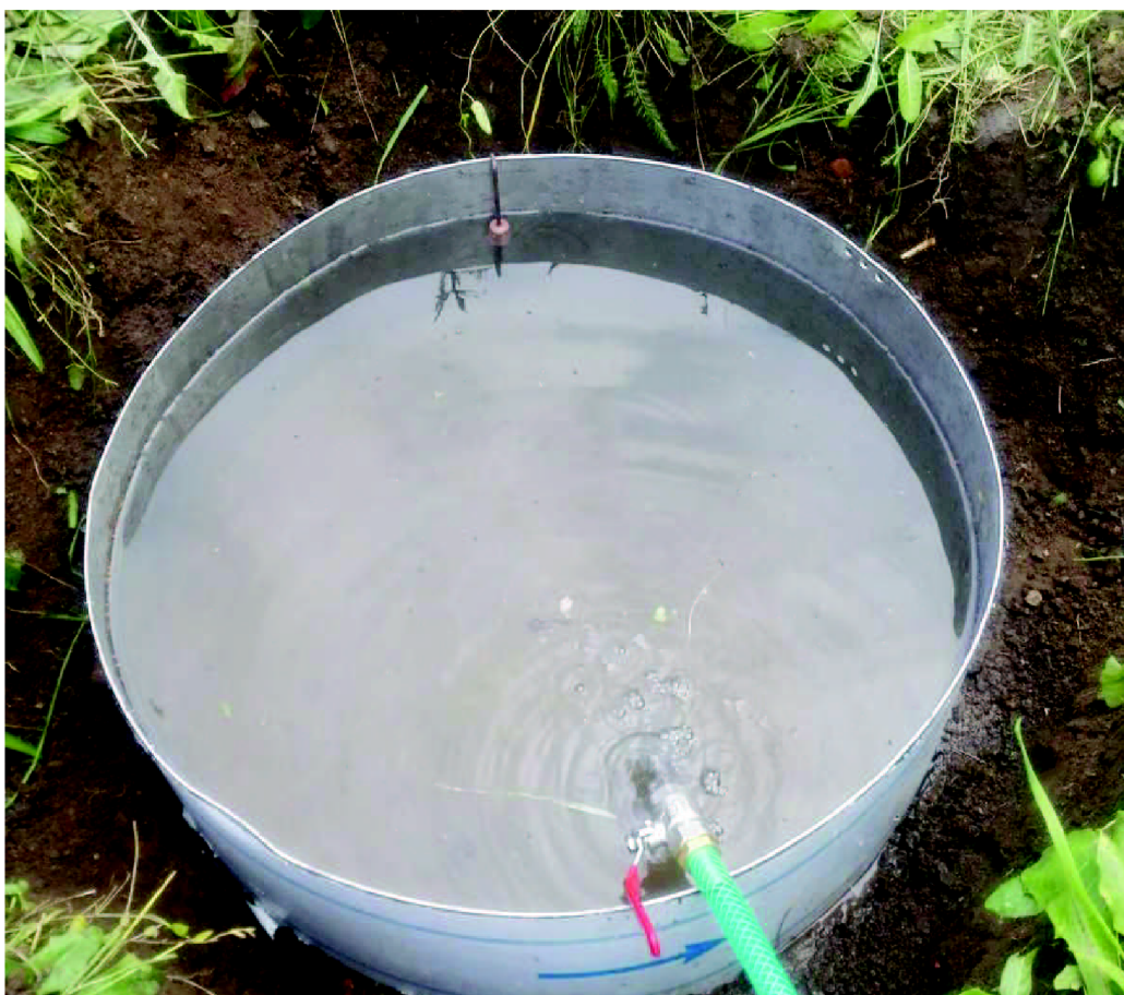
Obr. 11 Čerpání vody do vsakovacího válce
