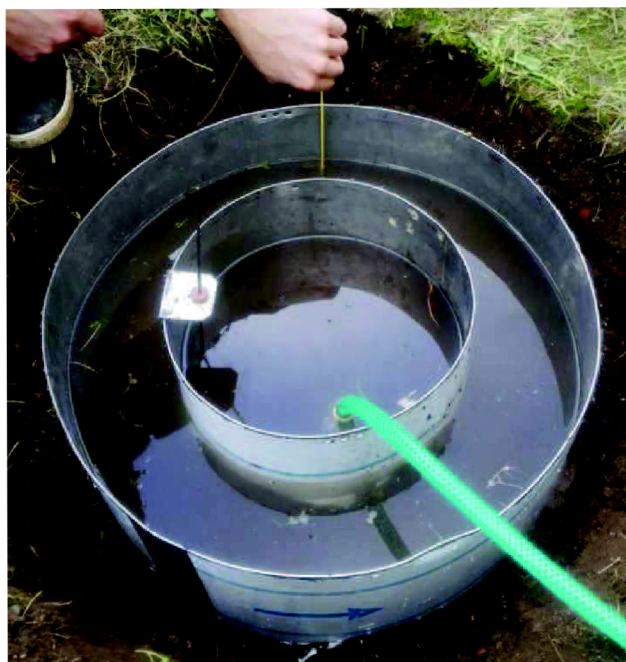
Plnění vsakovacího dvoje válce
