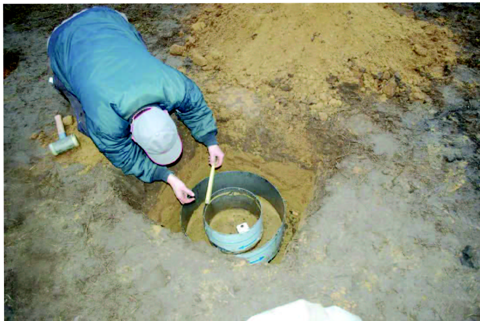
Měření hloubky zaražení válce
