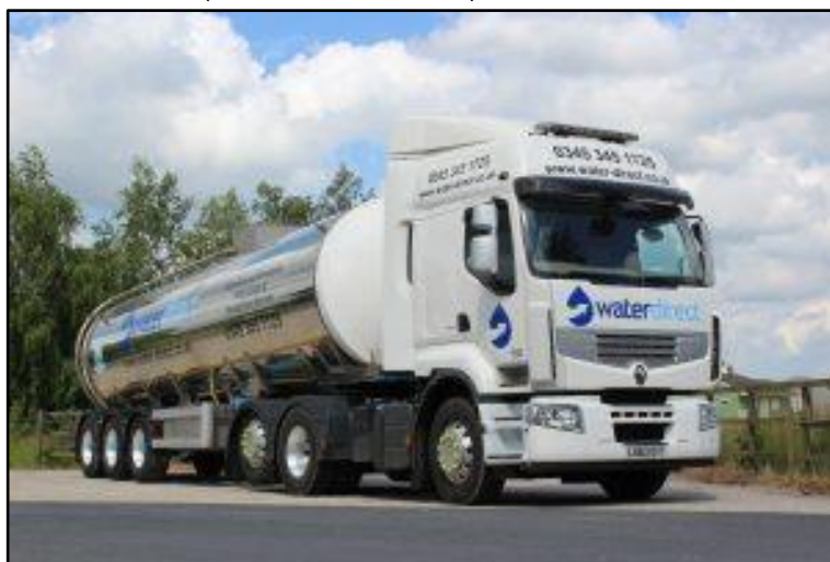
Obr. č. 21: Cisterna na vodu o objemu 30 000 l. (Zdroj: Water Direct 2019)
