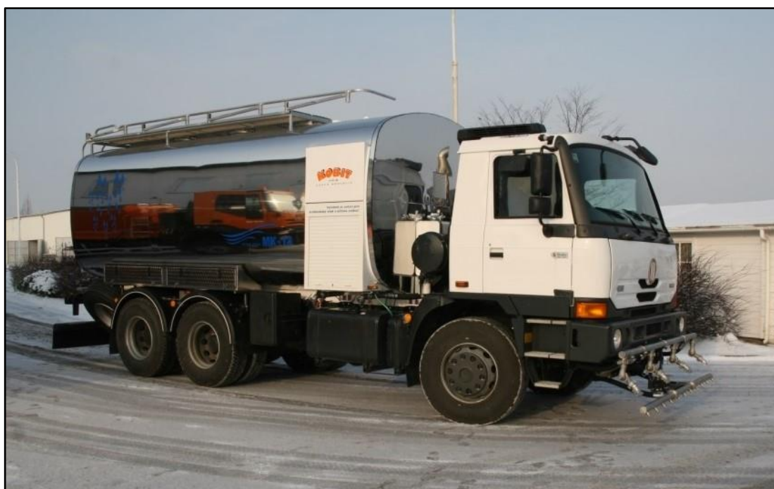
Obr. č. 3: Cisternové vozidlo s pevnou nástavbou CAV o objemu 13,3 m 3 (Zdroj: KOBIT 2019a)
