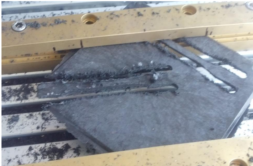
Obr. 3.16: Ukázka frézované destičky s otevřenou konturou
