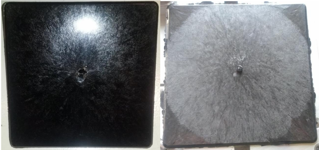
Obr. 3.4: Destičky pro určení míry anizotropie mech. vlastností porovnávaných technologií, vlevo vzorek s LGF vyroben konvenčním vstřikováním, vpravo vzorek s LCF vyroben kompresním vstřikováním
