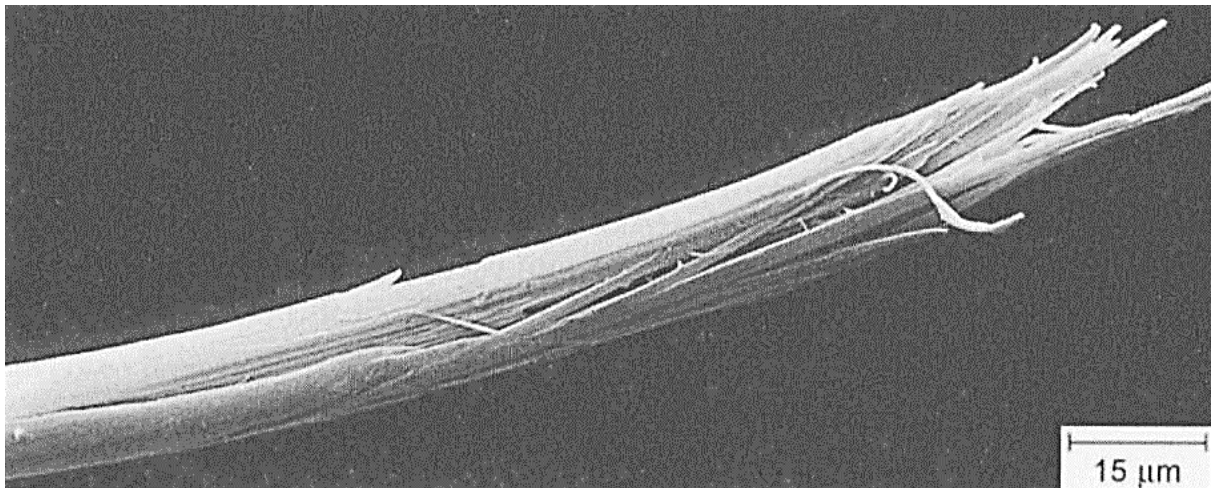
Obr. 2.5: Snímek aramidového vlákna pořízený elektronovým mikroskopem [3]
