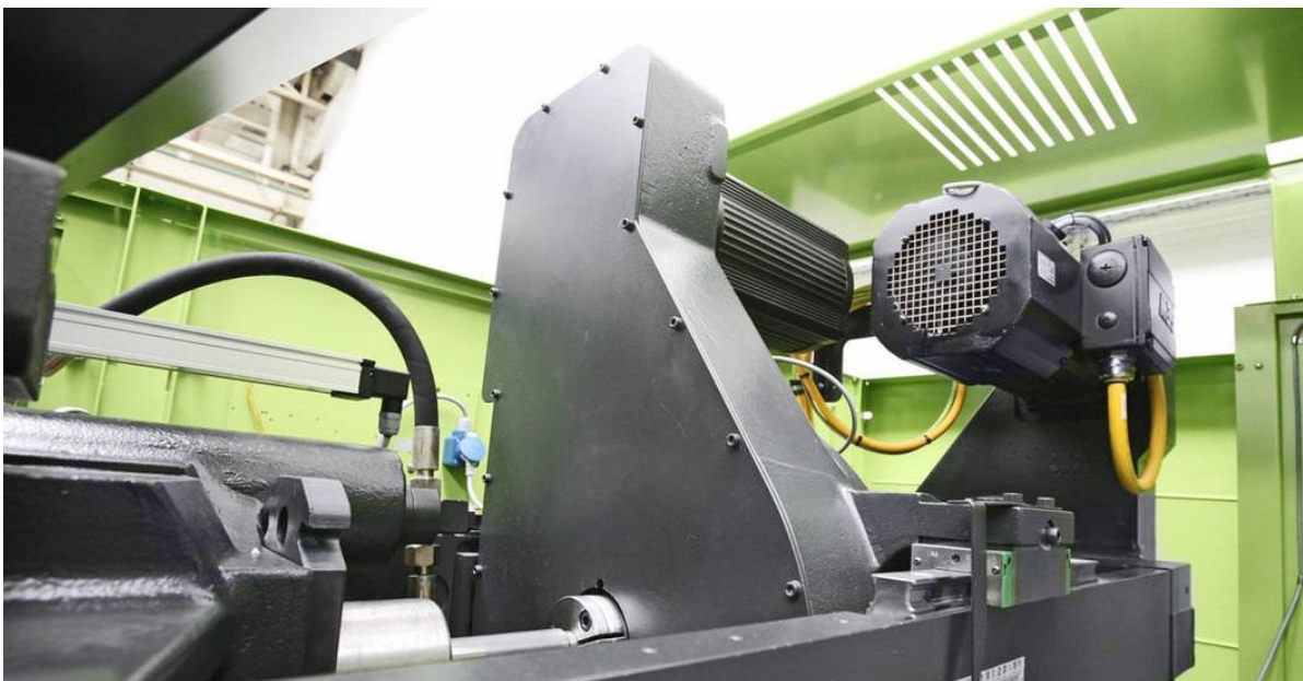
Obr. 34 Pohled na hybridní vstřikovací jednotku. [2]
