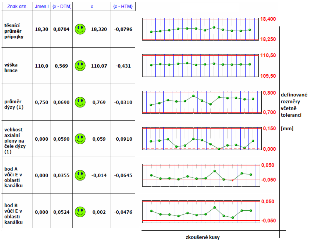
Obr. 29 Změřené rozměry hrnce z hydraulického stroje [3]
