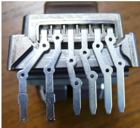
Obr. 18 Vkládané jádro se založenými piny
