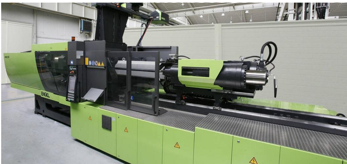
Obr. 35 Pohled na hydraulickou vstříkovací jednotku [2]
