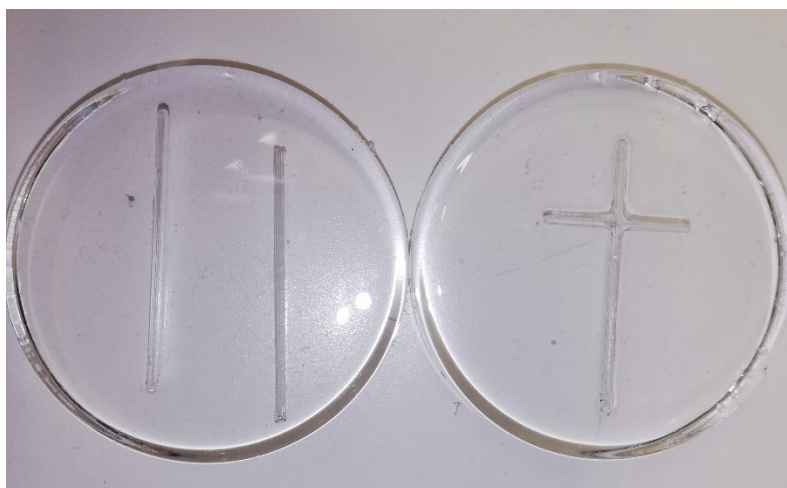
Obr. 17: Vzniklé kanály s PDMS po vyjmutí struktur
