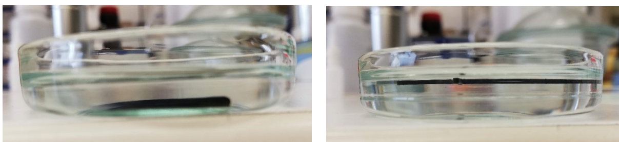
Obr. 16: Struktury v PDMS držící se u dna a povrchu
