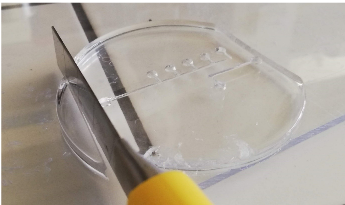
Obr. 34: Ořezávání PSMD na požadovanou velikost pomocí odlamovacího nože
