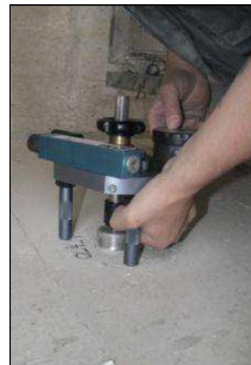
Obr. 5.2 Příklad odrhové zkoušky in situ.
