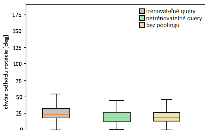
Obr. 5.5: Porovnanie experimentov pre sieť s attention. Graf vľavo patrí experimentu s trénovateľnými query vektormi, prostredný experimentu s netrénovateľnými query a pravý graf patrí experimentu bez pooling.
